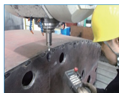
5軸加工機を用いた形状測定
