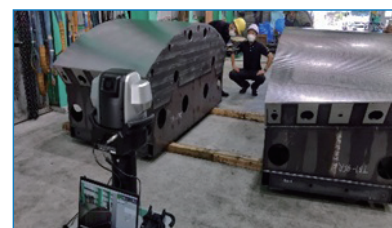
5軸加工機を用いた形状測定
