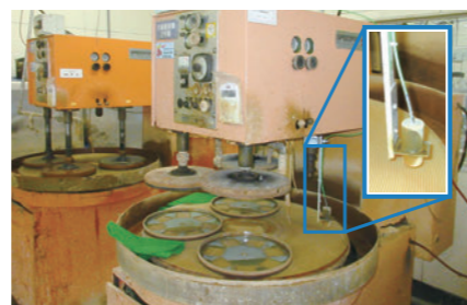
研磨盤に設置した温度センサー
