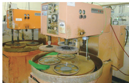
研磨盤に設置した温度センサー
