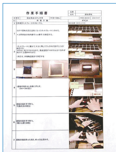
はがし作業の作業手順書
