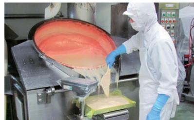
型への溶液流し込み
