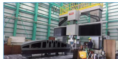
5軸加工機によるコンクリートセグメントの型枠部品の加工
