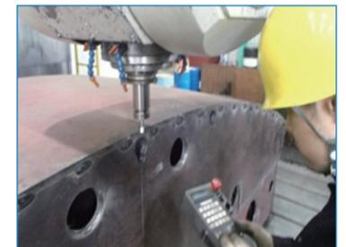
5軸加工機を用いた形状測定
